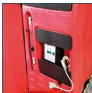
CARICA BATTERIE ON-BOARD CARGADOR DE BATERÍA INCORPORADO CHARGEUR DE BATTERIE EMBARQUÉ
