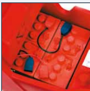
NO.2 BATTERIE 12V-110 Ah (20h)* 2 BATERÍAS 12 V-110 Ah (20h) 2 BATTERIES 12 V-110 Ah (20h)
